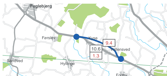
FIGUR 6.4 Forventet årsdøgntrafik i 1.000 køretøjer i forslag KN i 2025 (røde tal med forslag KN, grå tal i basissituation)
