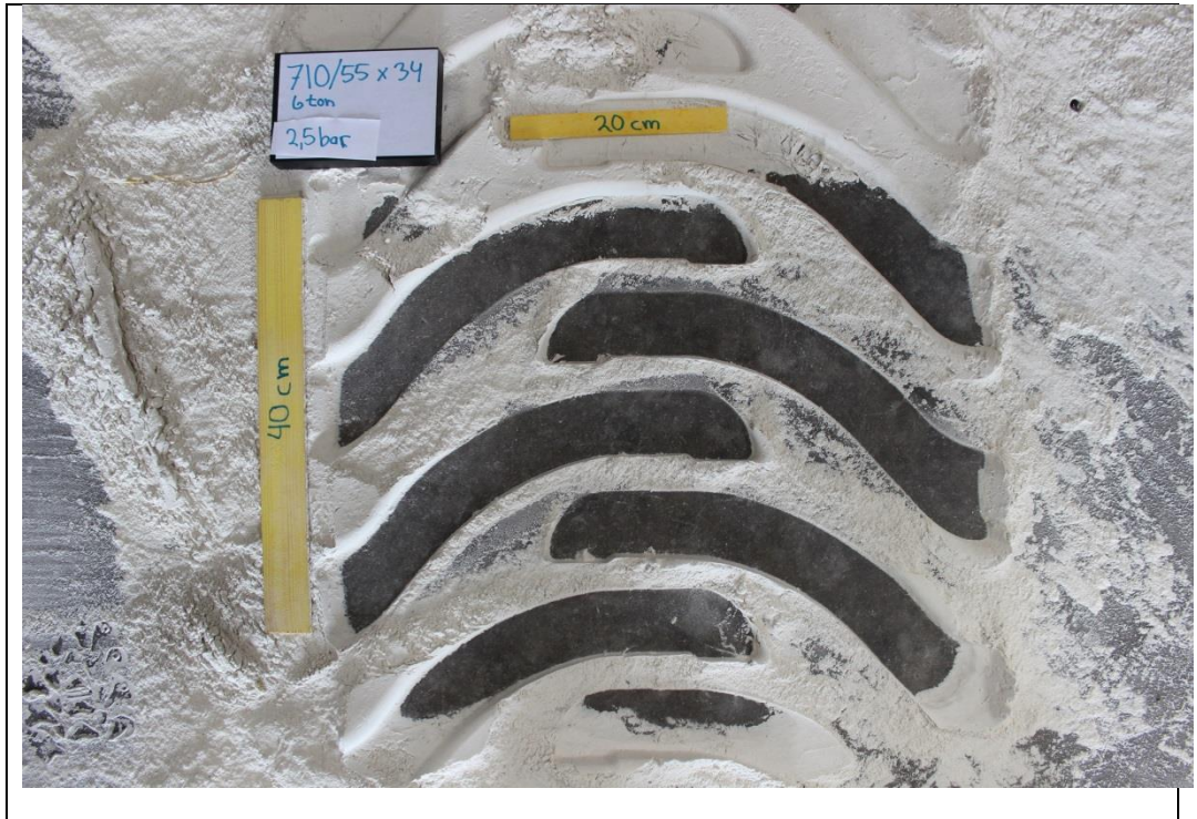
Gyllevognsdæk 710/55x34. Kontaktfladeareal på fast gulv afmærket med mel.
