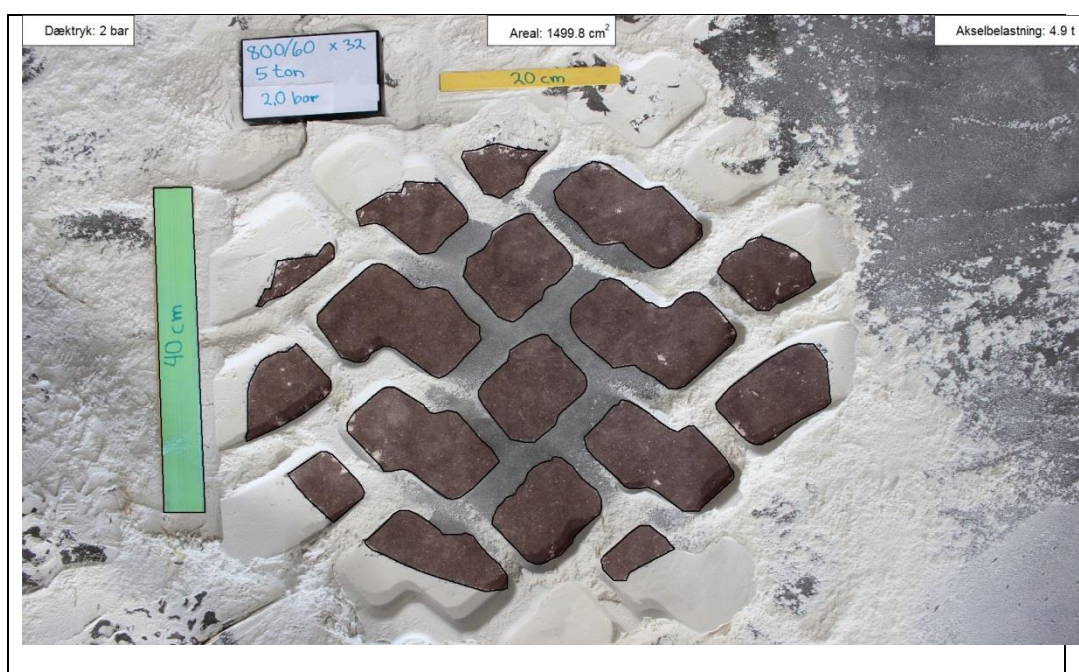
Gyllevogndæk 800/60x32. Kontaktfladearealet opmærket og beregnet.
