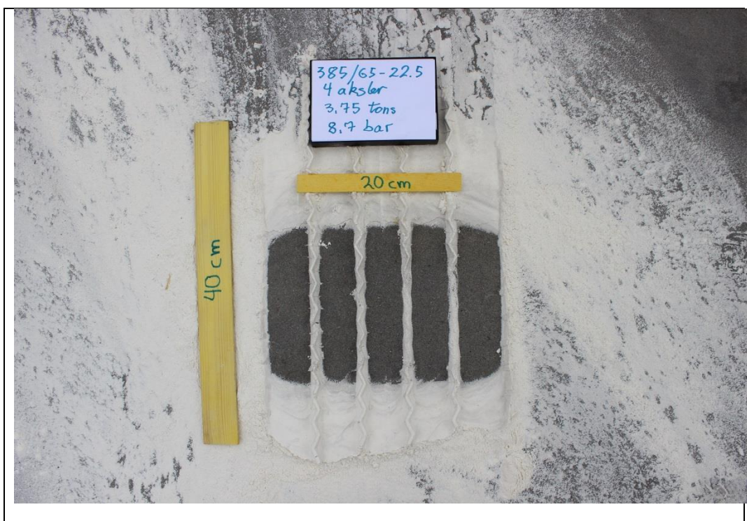
Lastvognsdæk 385/65-22.5 på 4-akslet trailer. Kontaktfladeareal på fast gulv afmærket med mel.
