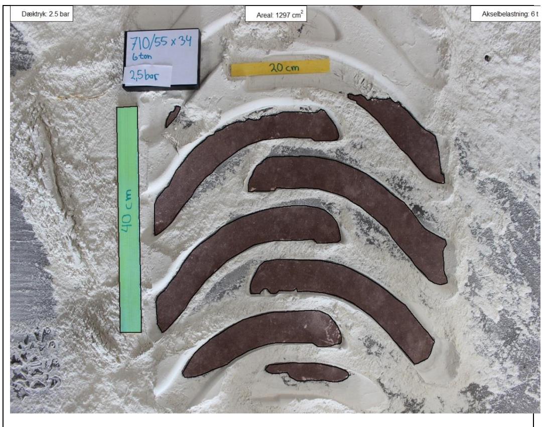
Gyllevognsdæk 710/55x34. Kontaktfladearealet opmærket og beregnet.
