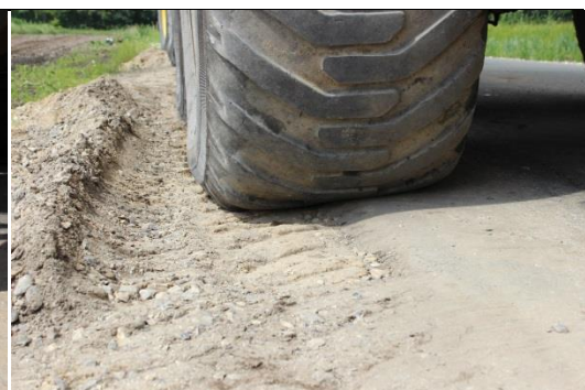
6 tons hjullast, ca. halvdelen af dæk- bredde på asfalt.
