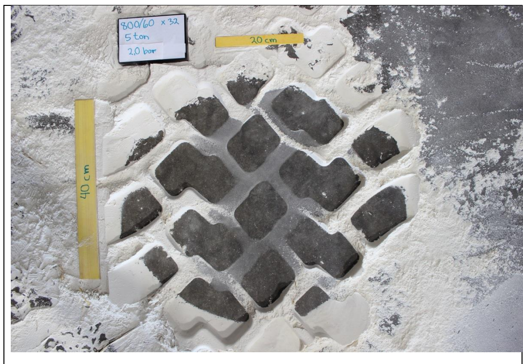
Gyllevogndæk 710/55x34. Kontaktfladeareal på fast gulv afmærket med mel.
