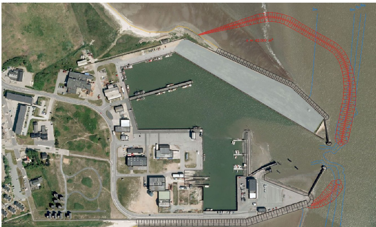
Rømø Havns havneværker med ydermolerne markeret med sort, og den påtænkte ændring af ydermolerne markeret med rødt.
