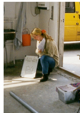
Afmærkning på punkt, hvorfra der skal udtages prøver af poreluften under værkestedet. Poreluften er den luft som er nede i jorden.
