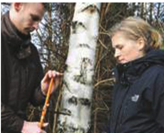
Udtagning af prøve fra et træ. Træprøver kan vise om der er forurening i grundvandet.
