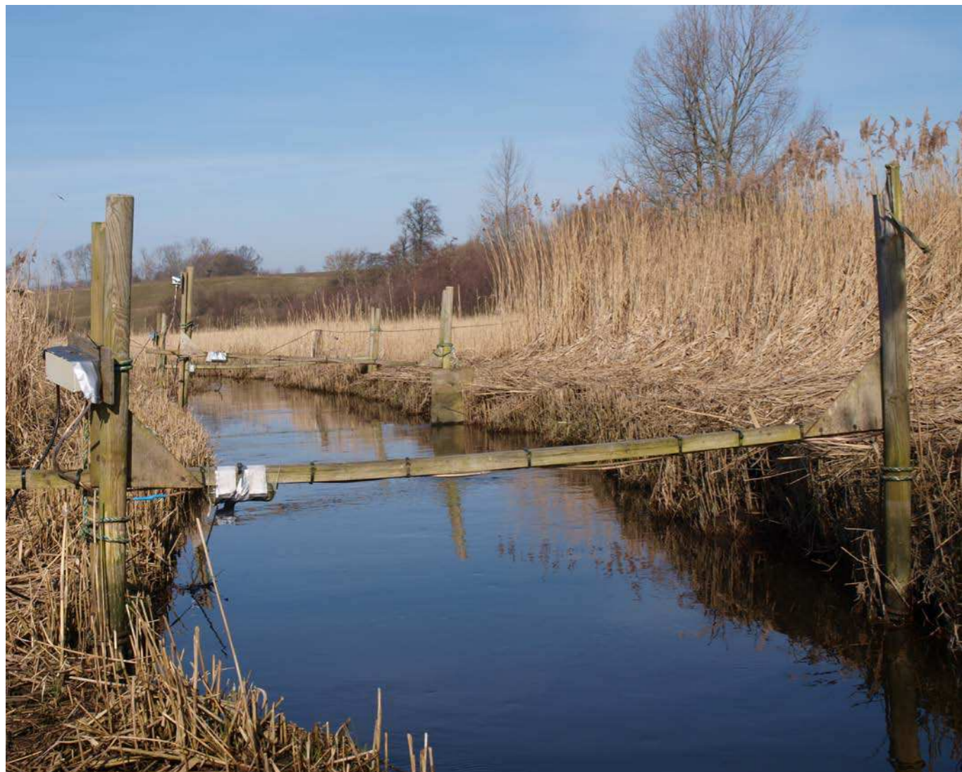
Antennestationen i Syltemade Å registrerede, hvor mange smolt der passerede ud mod saltvand. Da en stor del af smoltene ikke passerede, blev fokus rettet på de lokale skarvkolonier.
