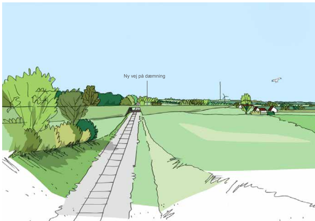
FIGUR 6.3 Visualisering - Ved krydsningen af jernbanen hæves motorvejen på en dæmning, Dette giver bilisterne et flot kig ud over landskabet, men vejen vil her blive synlig i området.
