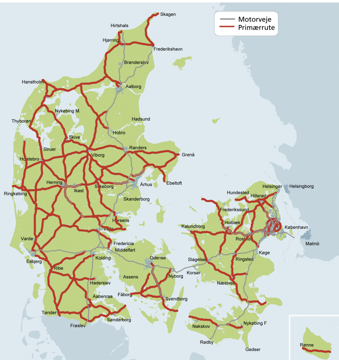
Figur 1.2 Det primære rutenet. På kortet er det primære rutenet vist med rød, og motorvejene med grå. Enkelte af primærruterne er motorvej, og indgår derfor ikke i HVU's undersøgelse. Ikke alle de viste landeveje indgår i undersøgelsen.
