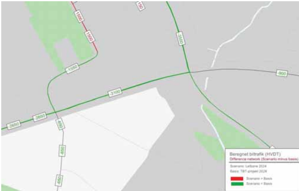
Figur 6-3: Forskelskort for biltrafik i 2024 mellem scenarierne med og uden letbanen på Niels Bohrs Allé og Campusvej. Grøn farve angiver, at der i scenariet med letbanen er mindre biltrafik end i scenariet uden letbane. Uden letbanen er trafikmængden på vejene omkring Campus så stor, at der vil opstå problemer med at afvikle trafikken i området.
