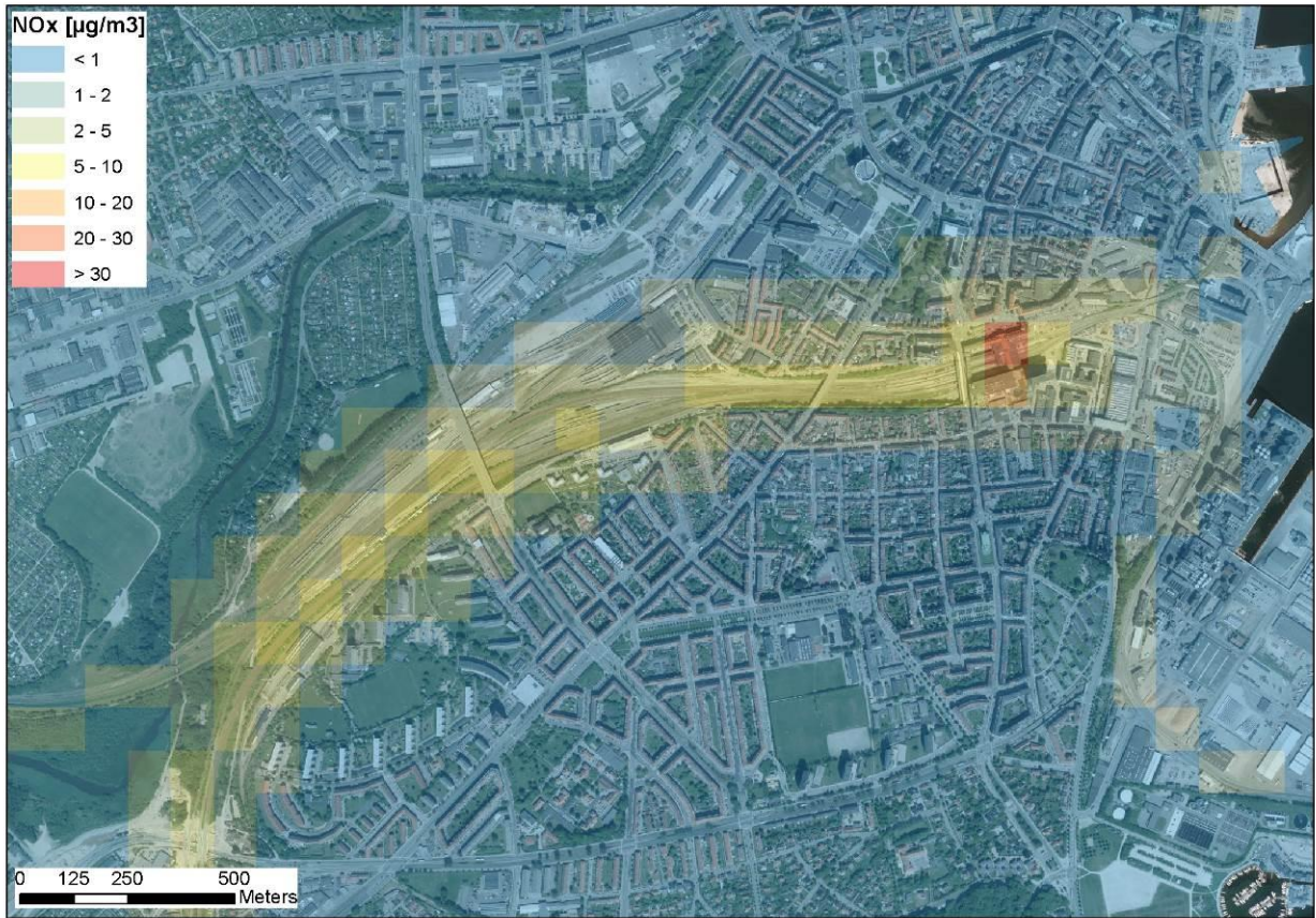
Figur 15 Bidrag fra togtrafik i Aarhusområdet til koncentrationen af NOx. Som ovenfor, men fokus på området omkring Banegården i Aarhus.
