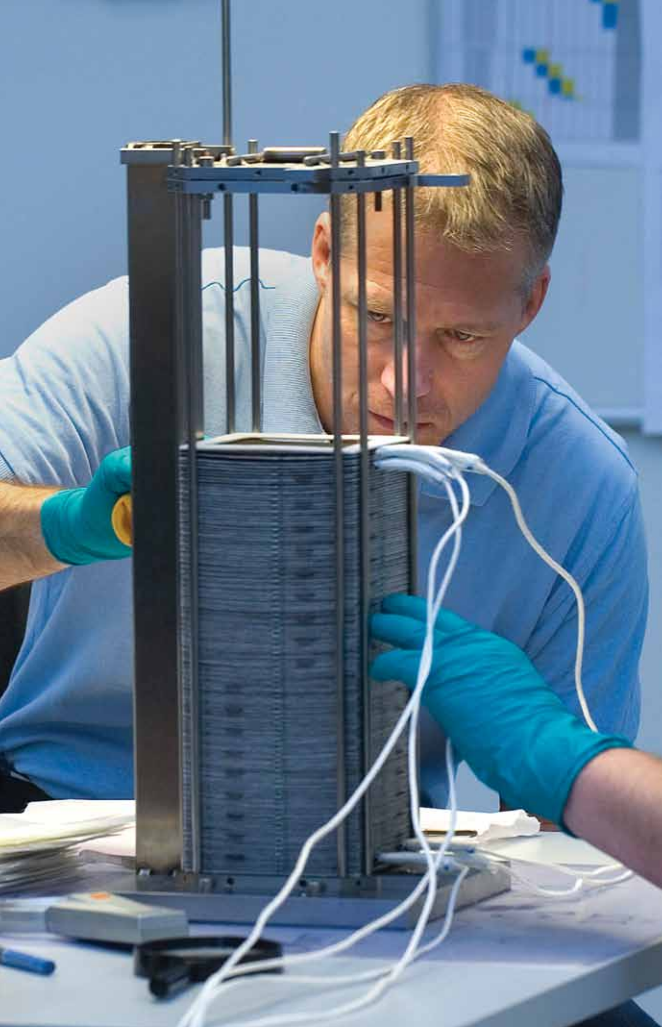
Brændselsceller stablet i en brændselscellestak. Foto: Poul Rasmussen
