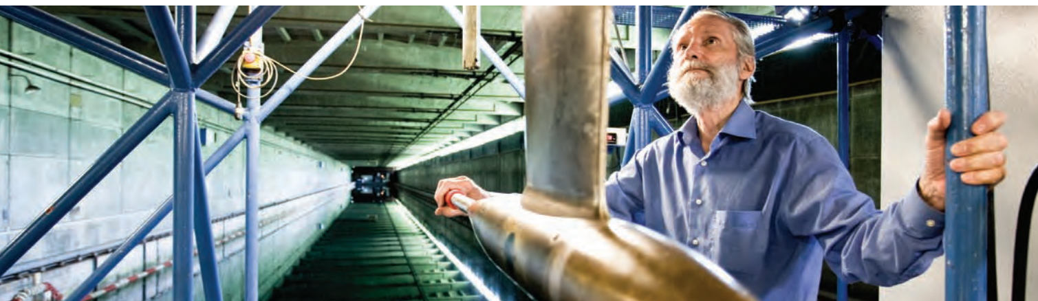
Skibsingeniør udfører propeltest med åbenvandsdynamometer i vandtanken hos FORCE Technologys division Maritim Industri i Lyngby.
