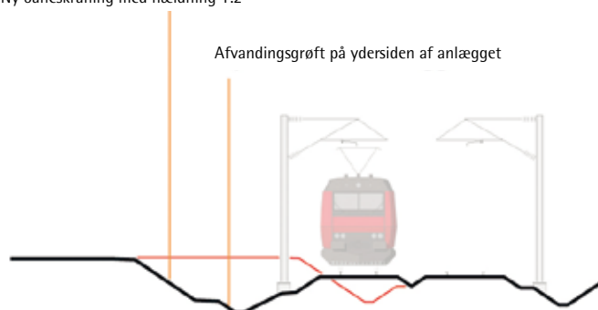
Snit i bane i afgravning - før (rød linje) og efter udvidelse af baneanlægget ved 160 km/t
