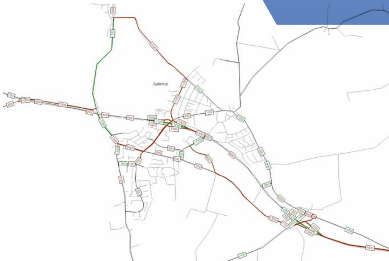
FIGUR 4.29 Forskel i trafik - variant med to tilslutningsanlæg (øst og midt) i forhold til 0-alternativet (årsdøgntrafik i 2020)
