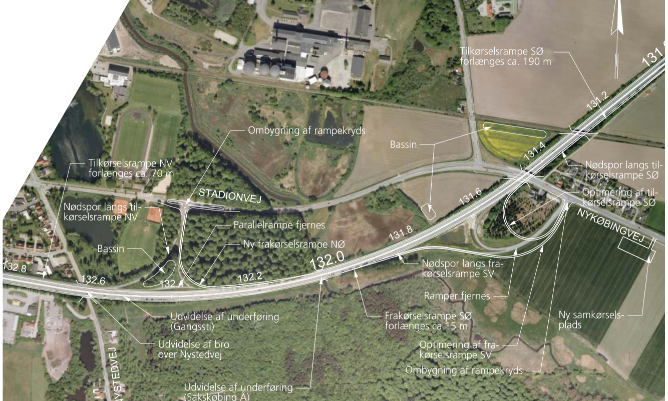
Figur 4.3: Forslag til ombygning af tilslutningsanlæg 46 Sakskøbing
