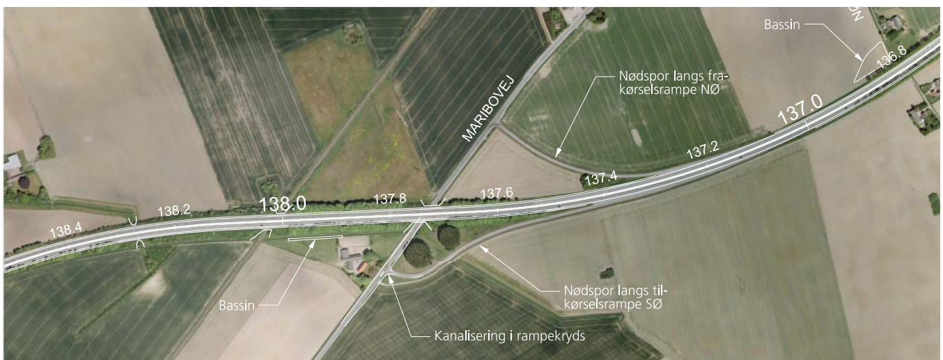
Figur 4.4: Forslag til ombygning af tilslutningsanlæg 47 Våbensted
