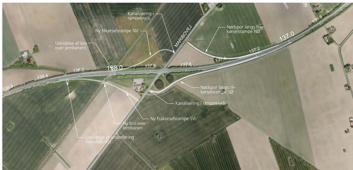
Figur 12.3: Forslag til nye vestvendte ramper i forbindelse med tilslutningsanlæg 47 Våbensted
