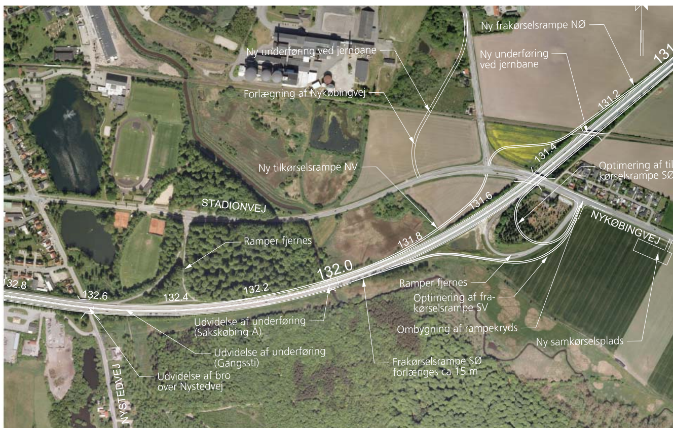
Figur 12.1: Alternativt forslag til ombygning af tilslutningsanlæg 46 Saksøbing
