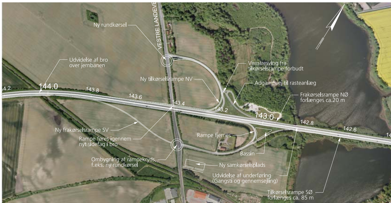
Figur 4.5: Forslag til ombygning af tilslutningsanlæg 48 Maribo
