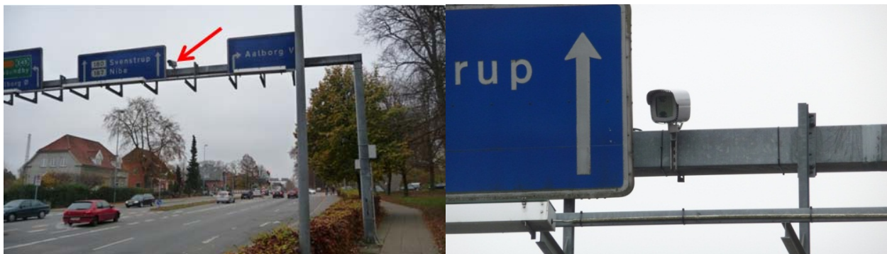
Figur 5 Videokamera til automatisk nummerpladegenkendelse i Aalborg. Her brugt til at måle rejsetider
