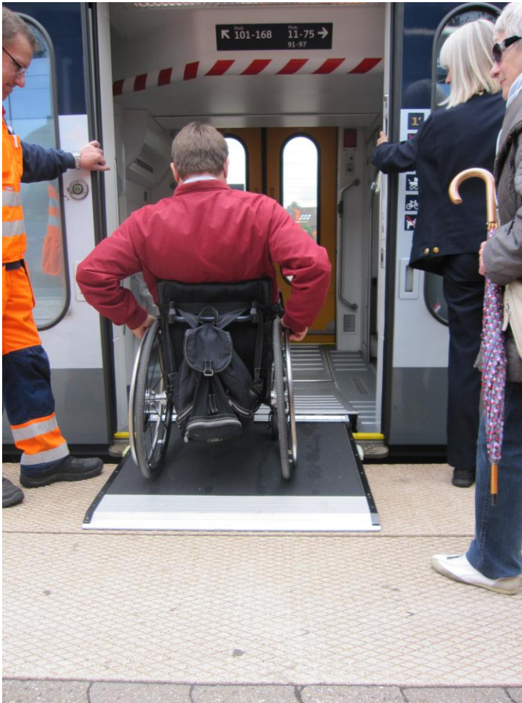
Fig. 12 – Adgang med den indbyggede rampe
