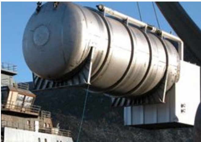
Vakuum isoleret tank fra CRYO AB
