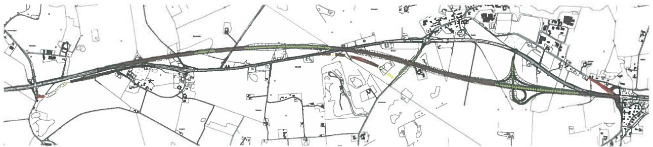
Figur 7.5 Placering af afgravninger og påfyldninger, med rødt er angivet afgravning og med gult påfyldning
