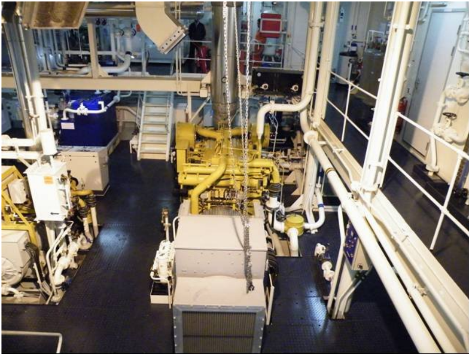
Hovedmotorer 2 Catepillar 3512 B-HD 1350 KW forsynet med EL generatorer 1100 KW
