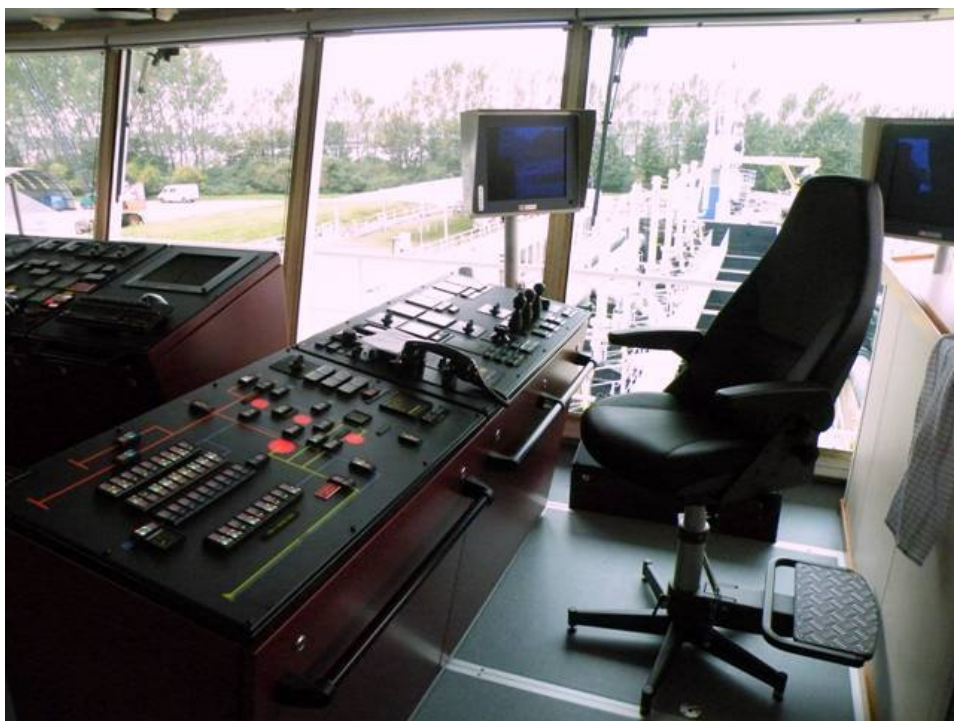
Her ser vi operatørens arbejdsplads hvorfra alle pumper og lemme styres Skibet kan således opereres af 2 mand og en kok.
