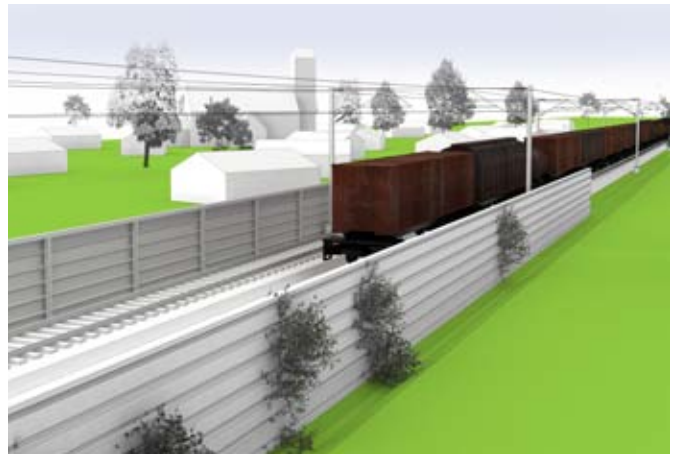
Støjskærme opstilles gennem flere af byerne – som udgangspunkt i en højde på to meter over skinneoverkant.
