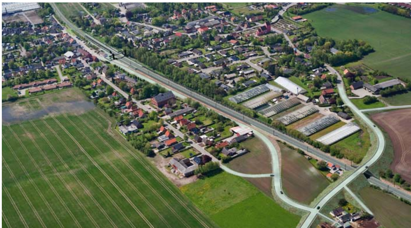
Overkørslen i Eskilstrup nedlægges, og Eskilstrup Vestergade lukkes permanent for trafik på tværs af banen. Broen for Tårngade over banen udskiftes, og der etableres en ny vej langs banen – fra Tårngade (nederst til højre) til Eskilstrup Station.
