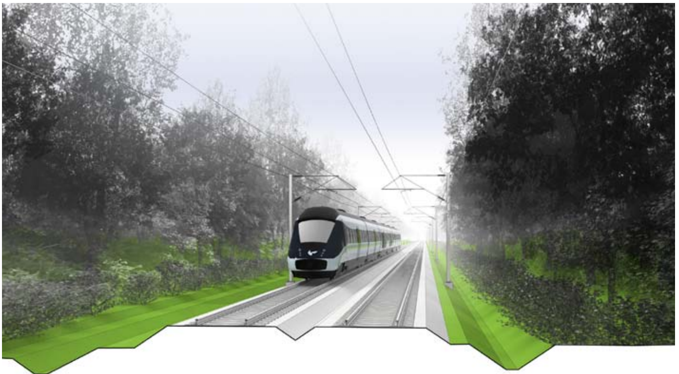
Typisk tværsnit fra strækningen, hvor der udvides fra et til to spor, og hvor der elektrificeres. Dæmnings geometri ændres.
