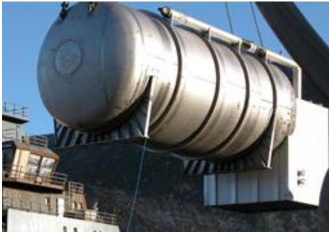
Vakuum isoleret tank fra CRYO AB
