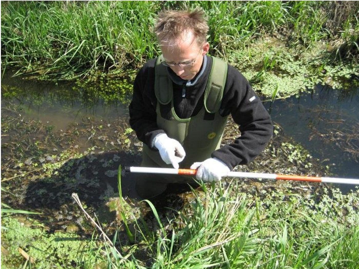
Figur 16. (Foto Jan Hjeds. Maj 2008.) Hovedledning fra større systemdrænanlæg, udløb i Elvedgårdsafløbet, station 1062. Vandløbsmyndigheden v. biolog Bent Nielsen, Nordfyns Kommune, har netop fundet hovedledningens udløb, og viser her, hvor langt overkant rør er under vandspejlet. I sommervandføring (lav afstrømning)!! Drænanlægget er anlagt til at have frit afløb til recipienten med underkant udløb over vandspejl ved middelfafstrømning for marts (høj afstrømning), og er dermed allerede før vandplanernes indsatskrav om nedsat vandløbsvedligeholdelse samt vandløbsrestaurering udsat for ødelæggende vandstuvning på grund af stærkt mangelfuld vandløbsvedligeholdelse. Vandløbsmyndigheden finder forholdene i orden!
