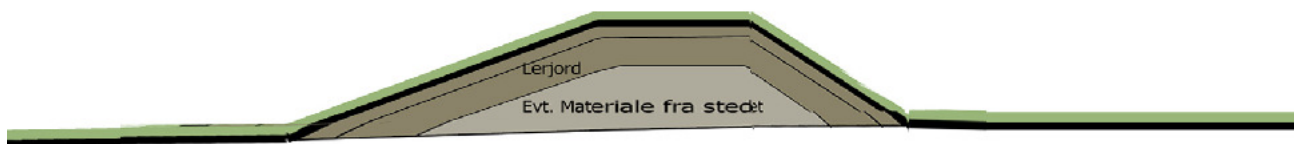
Eksempel på et profil af Vejledigerne/Dige syd for byen (principsnit). Digets forkant står på terræn 0,8 m. o. DVR 90: 1: 100
