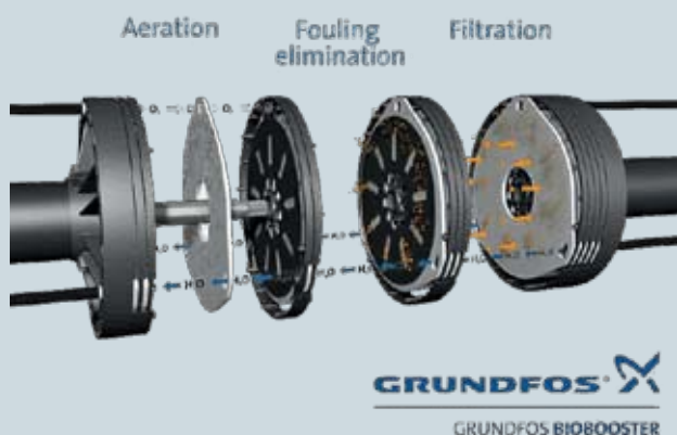
Figur 2 B. MBR-reaktoren består af roterende cross-flow impellere, som er placeret mellem de keramiske membrandiske til filtrering og udluftning. Impellerne forhindrer begroning og fremmer overførslen af ilt til den høje slamkoncentration i reaktoren. Tekst på figuren: Udluftning – fjernelse af smudsrester – filtrering.
