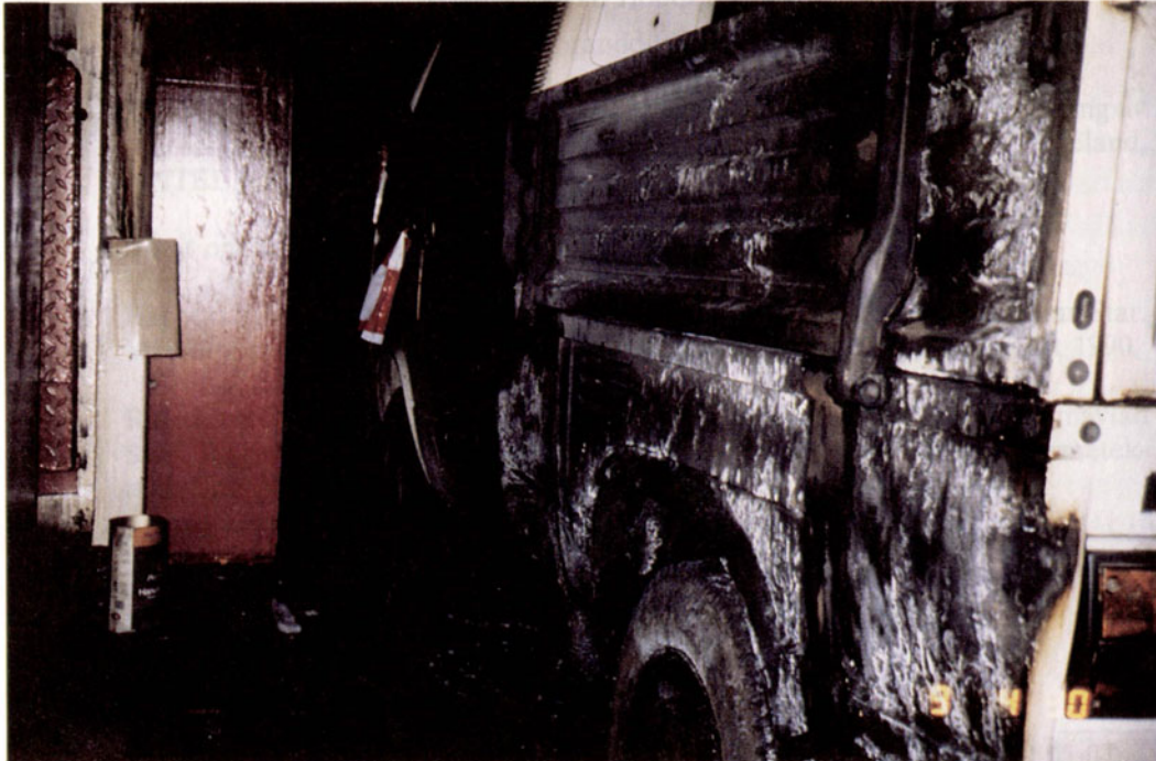
Figur 10. Bild visande brandskadad bil som har stått precis framför en öppen skjutdörr nr. 9 (A 60), se Figur 3, på bildäck. Hastigheten genom denna brandskjutport har vid försök uppmätts till 20 m/s utan de termiska effekterna av brand. Notera att denna hastighet avser kall luft. Vid en brandgastemperatur om ca 600°C ökar hastigheten med ca en faktor 3. Detta visar på hur stor inverkan ventilationssystemet har haft på huvudbranden.
