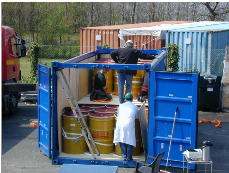
Figur 2. Registrering, pakning og transportsikring af tromler med tungt vand
