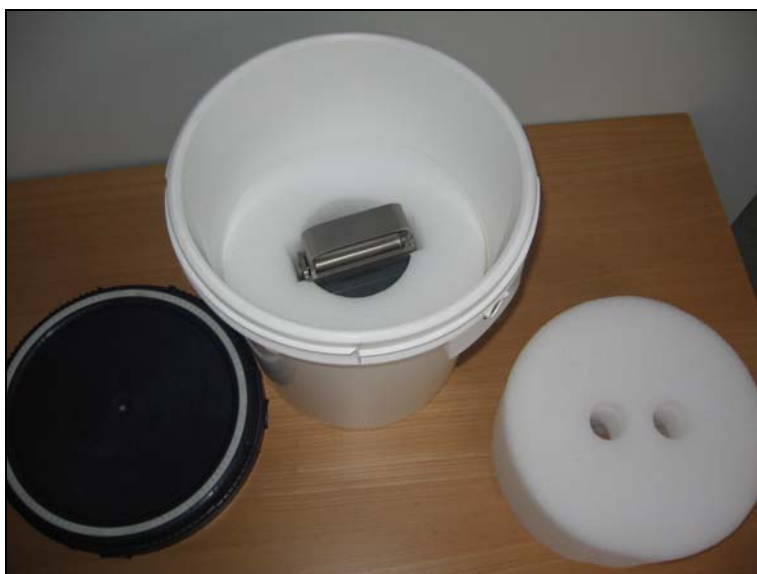
Figur 1. Testet og godkendt F18-FDG transportbeholder
