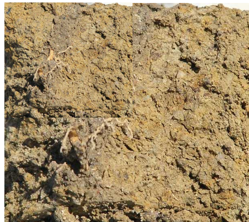
Hb2, fyld med recent rod i ormegang, læg mærke til prøvens "rodede" struktur. 0,5 mut.
