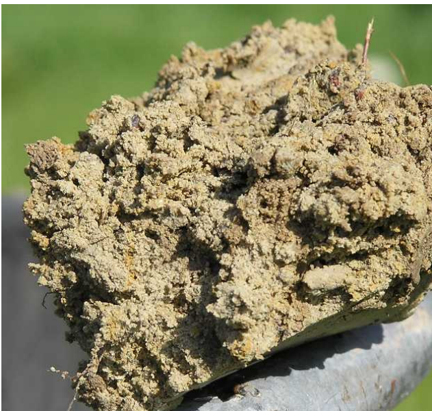
Moræneler, 0,5 mut. Læg mærke til de to sprækker med jernudfældninger der løber langs sedimentprøven. Der kan også ses en del rødder.
