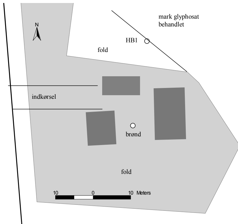
Figur 2 Placering af brønd og af håndboringer. HB - håndboring. Alle arealer hvor der er indsamlet oplysninger om brug af glyphosat er vist på skitse. Håndboring/håndboringer er tilstræbt placeret opstrøms anlægget.
