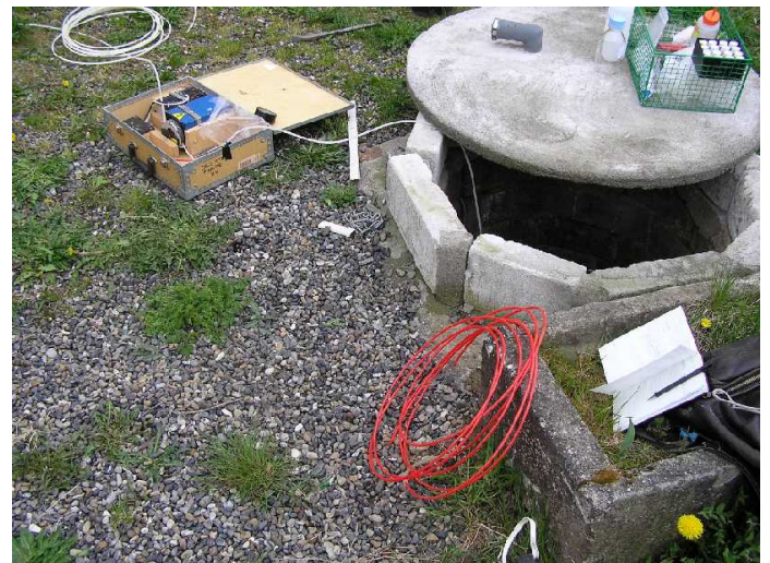
Prøvetagning af vandprøver fra gravet brønd. Brønden er 13 meter dyb og der blev udtaget vandprøver fra vandet i 1 meters dybde og fra 10 meters dybde. Bemærk grusbelægningen der støder op til en smal cementkant. Brønden er ikke aktiv og under nedlæggelse.
