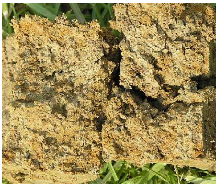
Moræneler med sprækker, lodret snit. Læg mærke til rødfarvede sprækker der dykker ind i billedet samt den lodrette sprække prøven er brækket langs. Prøven fremtræder skønet.
