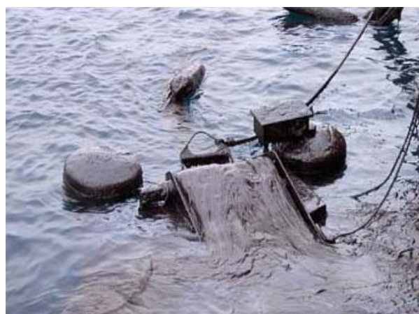
Bælteskimmer cassette til TERMINATOR. Beregnet på opsugning af tung olie med stor viskositet. En sådan olie kan ikke pumpes op med en TERMINATOR skimmer alene. Kan yderligere monteres med "High Water injection Flange", som tilsætter koldt eller varmt vand således, at selv tjæreagtig olie kan pumpes om bord på modtagerfartøjet uden at sidde fast i afgangsslangen.
