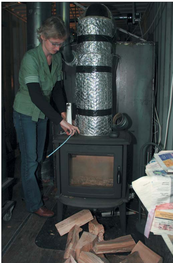
Marianne Glasius ved en forsøgsopstilling på Aarhus Universitet. Noget af røgen fra brændeovnen ledes under nøje styring til et klimakammer.
