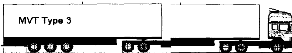
Modulvognstog type 3, bil til sættevogn-sættevogn-sættevogn.(60 ton)
