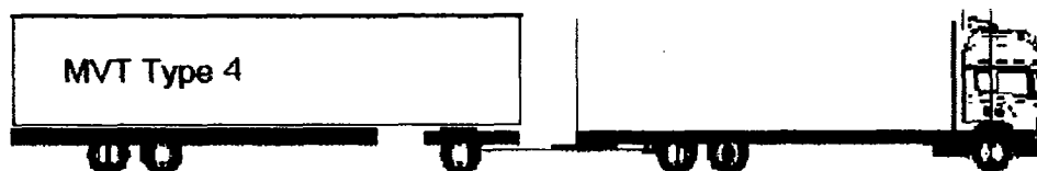
Modulvognstog Type 4, 12m lastbil – 12m påhængsvogn.(48 ton)
