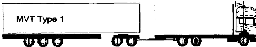
Modulvognstog type 1, lastbil-dolly-sættevogn. ( 60 ton)
