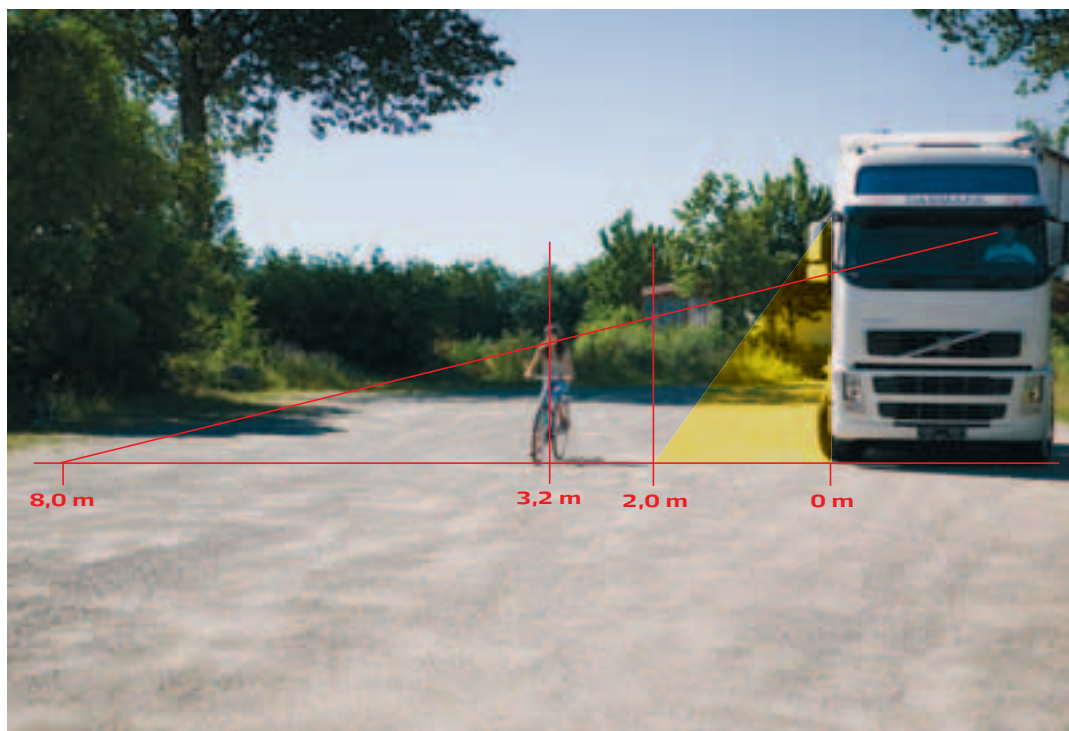
Billede 2.4: Den høje siderudeunderkant gør, at cyklisten ikke er synlig for chaufføren i området fra 2 m til 3,2 m til højre for førerhuset (cyklisthøjde 1,5 m og forudsat lovlig indstilling af nærzonespejl)
