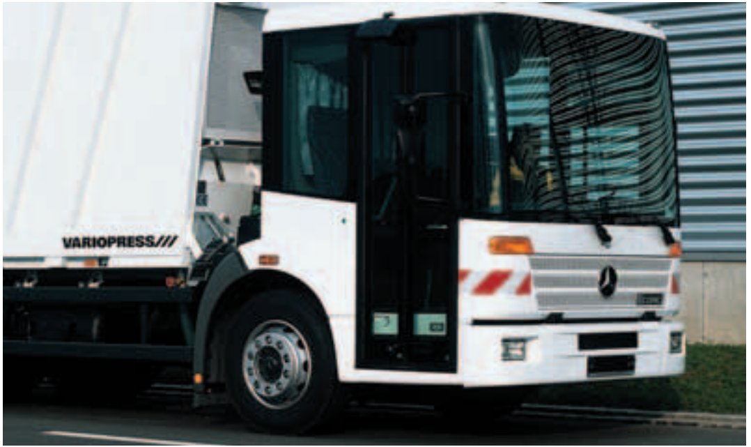
Billede 5.1: Eksempel på lavt førerhus med glasdør i højre side
