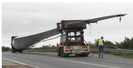
Transport af store møllelementer som for eksempel en vinge stiller krav til vejanlæggene. (Fotos: LM Glasfiber)
