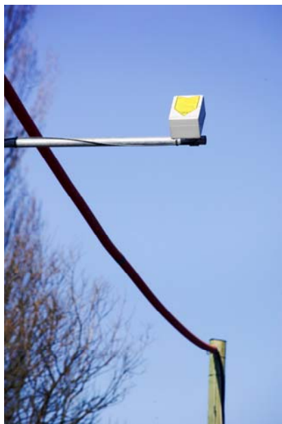
Figur 2. Radardetektor som bl.a. måler hastigheder, antal køretøjer, afstand mellem køretøjer og kørselsretning.
