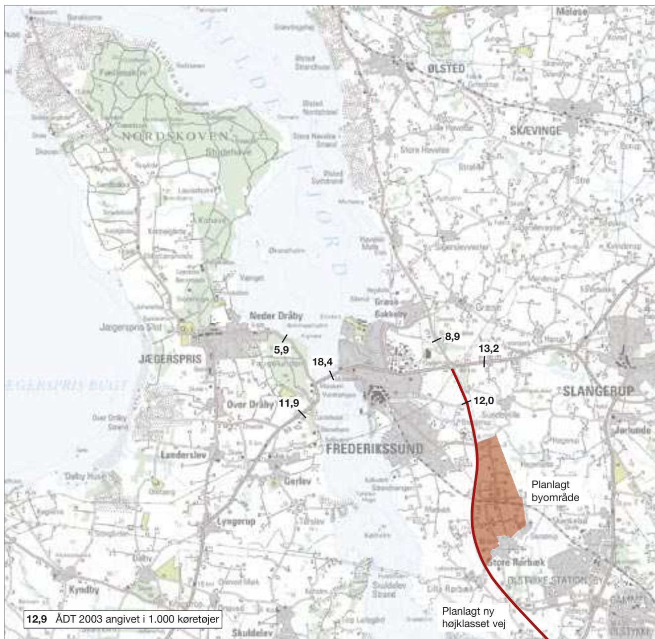
Figur 2.2 Kronprins Fredriks Bro indgår i det regionale vejnet mellem Hornsherred og hovedstadsområdet. En ny højklasset vej mod København er planlagt. Ligeledes planlægges nyt byområde syd for Frederikssund.
