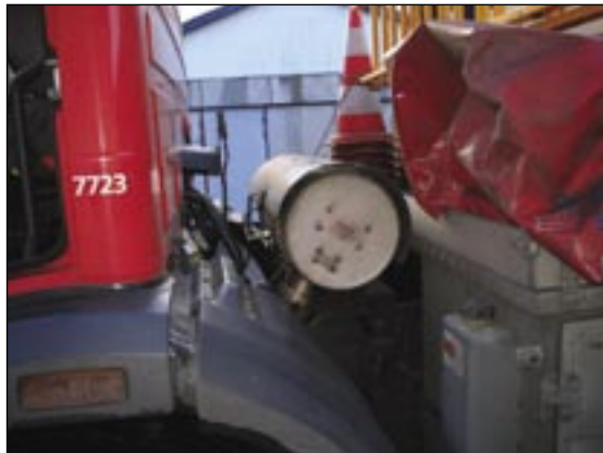
Lastbil fra Københavns Energi med partikelfilter, baseret på additiv.
