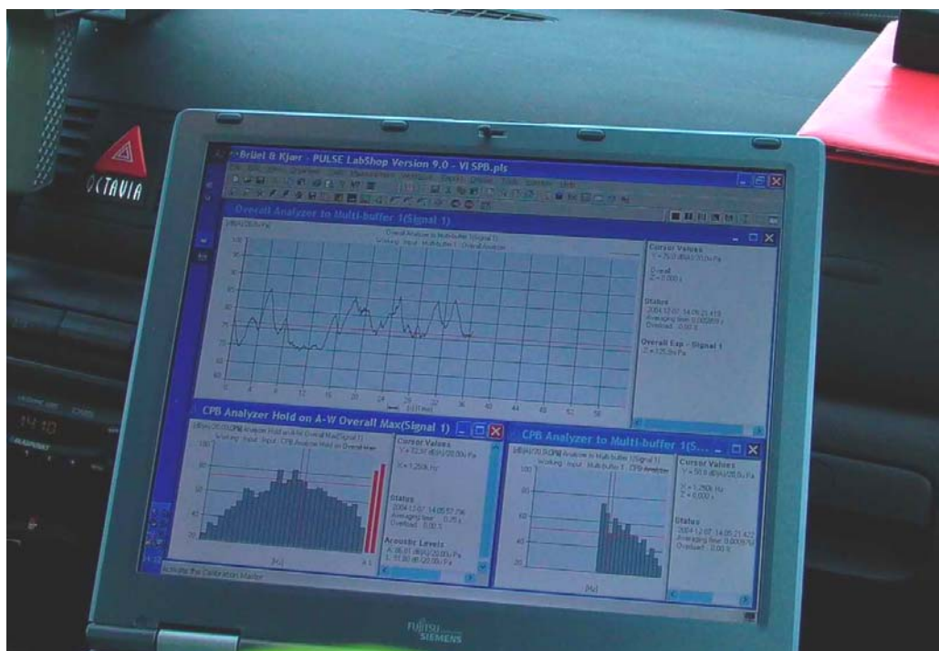
Figur 8. Støjmålingerne styres af en pc, som ligeledes opsamler alle måledata.
