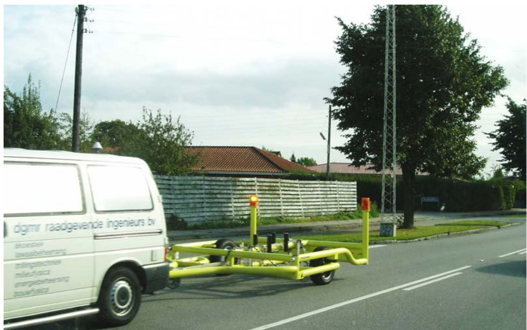
Figur 17. Trailer der blev anvendt til CPX målingerne på M10 ved Solrød.
