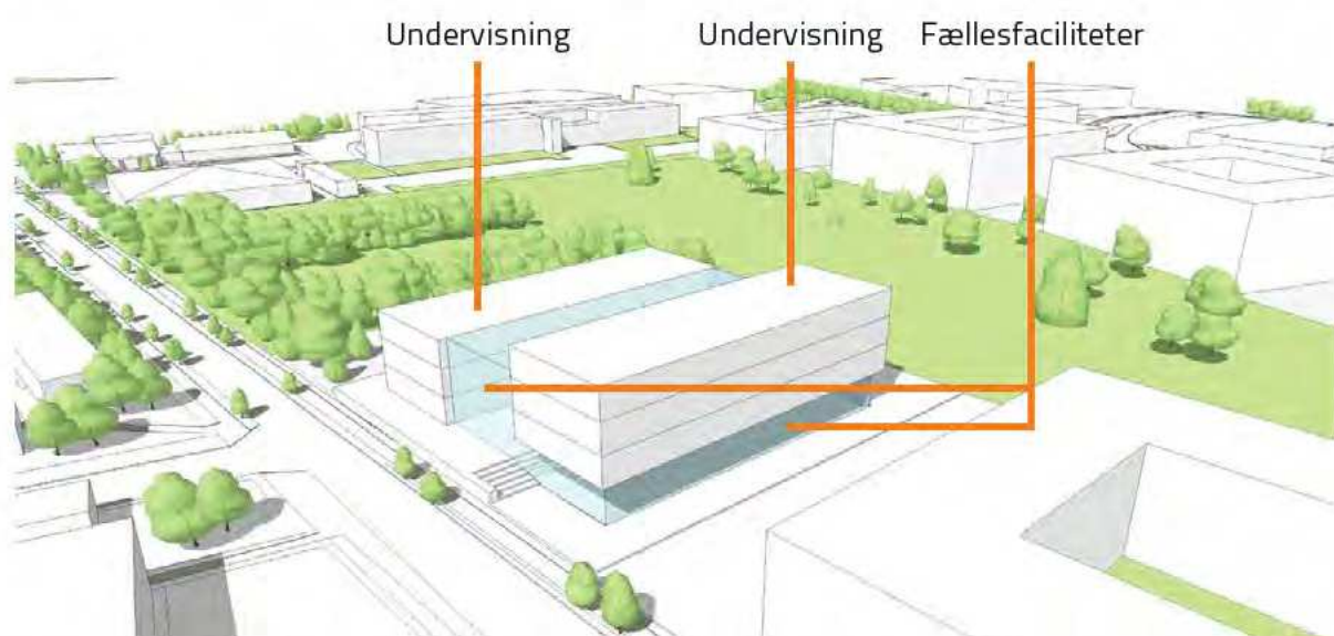
Undervisningslokalerne løftes op, og der etableres uddannelsessekretariat, videnscenter, kantine, træningslokaler, administration og kontorfaciliteter i stueplan.
