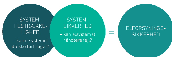
FIGUR 2: ILLUSTRATION AF ELFORSYNINGSSIKKERHED, SOM BESTÅR AF SYSTEMSIKKERHED OG SYSTEMTILSTRÆKKE-LIGHED, DER I PRAKSIS ER TO DELVIST OVERLAPPENDE BEGREBER.
